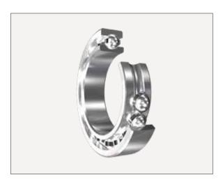
内輪幅を外輪幅より 0.397mm (1/64 インチ) ずつ両側 に拡げたインチ系の深溝玉軸受である。この軸受を使用する と、軸受周りの設計や組立てが簡単になる。
