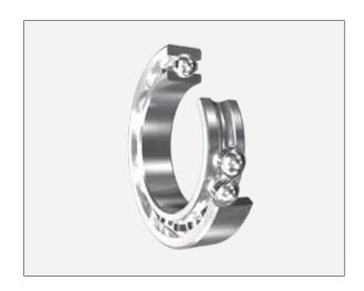
内輪・外輪に設けられた軌道の溝は、転動する玉の半径よ り、わずかに大きい半径の円孤の横断面をなしているラジア ル玉軸受である。
