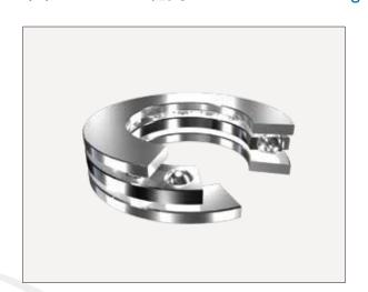
軌道みぞのない平らな軌道盤と、玉を組み込んだ保持器か ら構成されている。一方向のアキシアル荷重だけを負荷するこ とができる。軌道が平面なので、摩擦トルクは小さい。低速 回転に用いられる。
