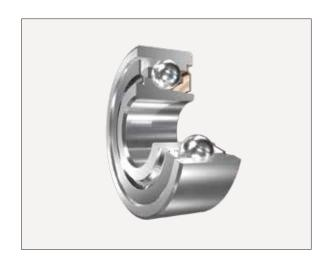
ラジアル荷重と一方向のアキシアル荷重を負荷することがで きるミニチュア玉軸受。アキシアル負荷能力が高く、負荷を受 ける側の内輪および外輪の溝は深い。接触角を 45°にして、 アキシアル剛性が大きい。両側が鋼板でシールドされ、グリー スが封入されている。通常 2 個の軸受を対向させ、内部すき まを調整して使用する。
