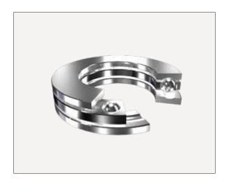
上下の軌道盤に軌道みぞを付けたことにより、より高い定格 荷重を確保した。また、軌道みぞが付くことにより回転時のボー ルと保持器の動きを抑えることでシャフトやハウジングへの接触 を軽減している。
