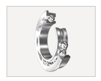
外輪の片側につばをもった深溝玉軸受である。この軸受を使 用する場合、ハウジング内径に肩を設ける必要がないので、精 度の高い通し穴加工ができる。
