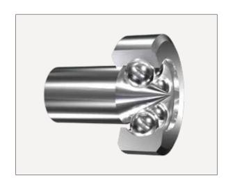
外輪及び数個の玉から成り、回転軸の先端の円すい部(通 常 60°のピボット) を支える玉軸受である。玉のピッチ径が小 さいことと軸のピボット部の形状から、摩擦トルクは小さい。
