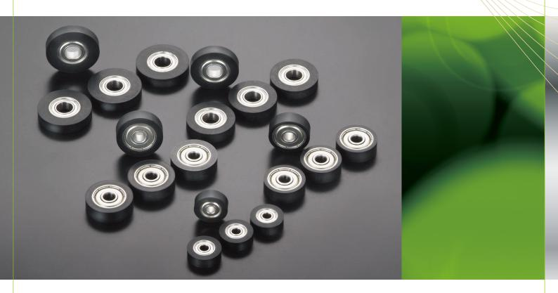
ミニチュアボールベアリングの外輪に、ウレタンゴムを焼付け接着&研磨仕上げ。 高精度・低振動・低騒音が要求される搬送機器に幅広く使用されています。
